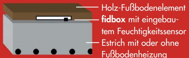
Maße: ca. 45 mm breit, 150 mm lang und 6 mm flach – einfach zum Einfräsen
